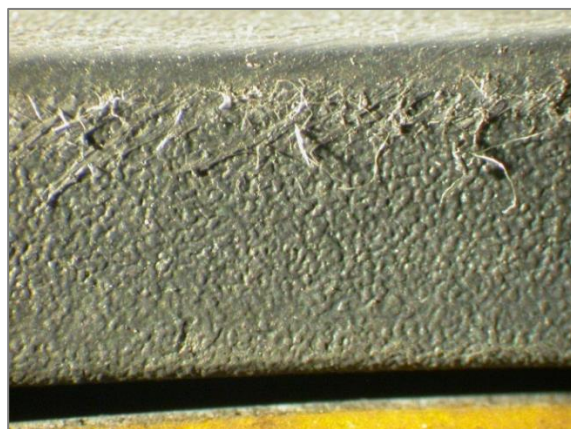
Figuur 4. Versmolten vezels in de nummerplaatouder van een auto.
